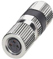
Connecteur, Universel, 3-pôles, connecteur femelle droit M8, détrompage: A, Raccordement rapide Piercecon<sup>®</sup>, matériau de la molette: Laiton, nickelé, diamètre extérieur du câble 3 mm ... 5 mm
