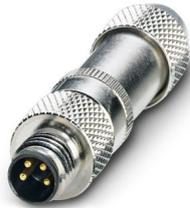
Connecteur, Universel, 4-pôles, blindé, connecteur mâle droit M8, détrompage: A, Raccordement soudé, matériau de la molette: Laiton, nickelé, diamètre extérieur du câble 3,5 mm ... 5 mm
