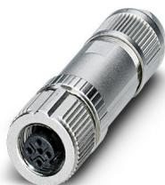
Connecteur de données, INTERBUS (500 kbit/s), 5-pôles, blindé, connecteur femelle droit M12, détrompage: B, Raccordement à ressort Push-Lock, matériau de la molette: Zinc moulé sous pression, nickelé, diamètre extérieur du câble 4 mm ... 8 mm
