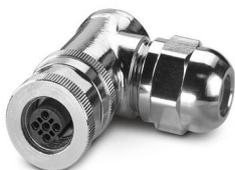
Connecteur de données, PROFIBUS, INTERBUS, 5-pôles, blindé, connecteur femelle coudé M12, détrompage: B, Raccordement vissé, matériau de la molette: Laiton, nickelé, presse-étoupe Pg9, diamètre extérieur du câble 6 mm ... 8 mm
