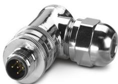
Connecteur de données, PROFIBUS, INTERBUS, 5-pôles, blindé, connecteur mâle coudé M12, détrompage: B, Raccordement vissé, matériau de la molette: Laiton, nickelé, presse-étoupe Pg9, diamètre extérieur du câble 6 mm ... 8 mm
