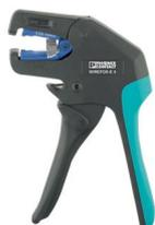
Outil à dénuder, pour câbles et conducteurs (spécialement aussi pour isolants en caoutchouc et silicone) de 0,1 - 4 mm<sup>2</sup>, réglage automatique, longueur à dénuder jusqu'à 18 mm, capacité de sectionnement jusqu'à 10 mm<sup>2</sup> flexible/ 1,5 mm<sup>2</sup> rigide, couteau de dénudage remplaçable
