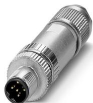
Connecteur de données, INTERBUS (500 kbit/s), 5-pôles, blindé, connecteur mâle droit M12, détrompage: B, Raccordement à ressort Push-Lock, matériau de la molette: Zinc moulé sous pression, nickelé, diamètre extérieur du câble 4 mm ... 8 mm
