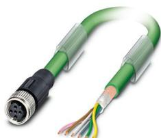
Câble préconfectionné pour bus, INTERBUS (16 Mbit/s), 5-pôles exempt d'halogène, blindé, extrémité libre, sur Connecteur femelle droit M12, détrompage: B, longueur de câble: Longueur au choix (0,2... 40,0 m)
