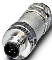
Connecteur de données, PROFIBUS, INTERBUS, 5-pôles, blindé, connecteur mâle droit M12, détrompage: B, Raccordement vissé, matériau de la molette: Zinc moulé sous pression, nickelé, presse-étoupe Pg9, diamètre extérieur du câble 6,5 mm ... 8,5 mm
