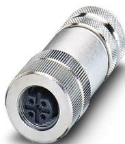
Connecteur de données, PROFIBUS, INTERBUS, 5-pôles, blindé, connecteur femelle droit M12, détrompage: B, Raccordement vissé, matériau de la molette: Zinc moulé sous pression, nickelé, presse-étoupe Pg9, diamètre extérieur du câble 6,5 mm ... 8,5 mm
