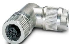
Connecteur de données, INTERBUS (500 kbit/s), 5-pôles, blindé, connecteur femelle coudé M12, détrompage: B, Raccordement à ressort Push-Lock, matériau de la molette: Zinc moulé sous pression, nickelé, diamètre extérieur du câble 4 mm ... 8 mm
