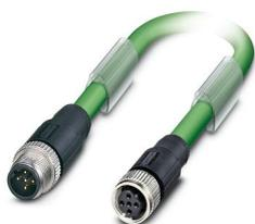
Câble préconfectionné pour bus, INTERBUS (16 Mbit/s), 5-pôles exempt d'halogène, blindé, connecteur mâle droit M12, détrompage: B, sur Connecteur femelle droit M12, détrompage: B, longueur de câble: Longueur au choix (0,2... 40,0 m)
