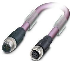
Câble préconfectionné pour bus, PROFIBUS (12 Mbit/s), 2-pôles exempt d'halogène, blindé, connecteur mâle droit M12, détrompage: B, sur Connecteur femelle droit M12, détrompage: B, longueur de câble: Longueur au choix (0,2... 40,0 m)
