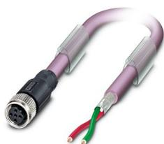
Câble préconfectionné pour bus, PROFIBUS (12 Mbit/s), 2-pôles exempt d'halogène, blindé, extrémité libre, sur Connecteur femelle droit M12, détrompage: B, longueur de câble: Longueur au choix (0,2... 40,0 m)
