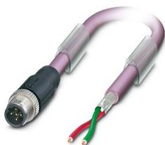
Câble préconfectionné pour bus, PROFIBUS (12 Mbit/s), 2-pôles exempt d'halogène, blindé, connecteur mâle droit M12, détrompage: B, sur extrémité libre, longueur de câble: Longueur au choix (0,2... 40,0 m)
