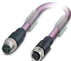
Câble préconfectionné pour bus, PROFIBUS (12 Mbit/s), 2-pôles exempt d'halogène, blindé, connecteur mâle droit M12, détrompage: B, sur Connecteur femelle droit M12, détrompage: B, longueur de câble: 0,3 m
