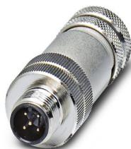
Connecteur de données, CAN Bus/DeviceNet, 5-pôles, blindé, connecteur mâle droit M12, détrompage: A, Raccordement vissé, matériau de la molette: Zinc moulé sous pression, nickelé, presse-étoupe Pg9, diamètre extérieur du câble 6,5 mm ... 8,5 mm
