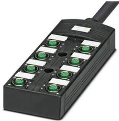
Boîtier répartiteur, application : Standard, type de raccordement: Connecteur femelle M12 SPEEDCONNEC Métal, nombre de prises: 8, nombre de pôles: 4, détrompage: A, affectation des prises: simple, affichage d'état: Oui, pnp; racc. câble multicond.: Connexion fixe 180°, PUR/PVC, longueur du câble: 5 m, blindage: non
