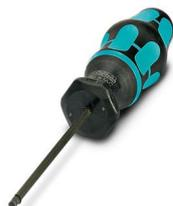
Tournevis dynamométrique, couple de serrage pré réglé de 0,4 Nm et entraînement hexagonal de 4 mm pour connecteur M12
