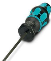
Tournevis dynamométrique, couple de serrage pré réglé de 0,2Nm et entraînement hexagonal de 4 mm pour connecteur M8
