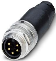
Connecteur, Universel, 5-pôles, connecteur mâle droit 7/8"-16UNF, détrompage: A, Raccordement vissé, matériau de la molette: Zinc moulé sous pression, nickelé, presse-étoupe Pg9, diamètre extérieur du câble 6 mm ... 8 mm, Contact 3 à fermeture
