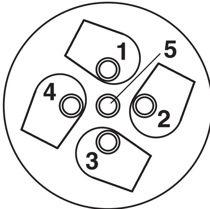
Côté connexion câble M12 (connexion vissée)
