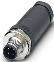
Connecteur, 4-pôles, connecteur mâle droit M12, détrompage: A, Raccordement vissé, matériau de la molette: Zinc moulé sous pression, nickelé, presse-étoupe Pg9, diamètre extérieur du câble 6 mm ... 8 mm
