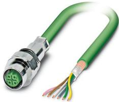
Embases paroi avant, INTERBUS (16 Mbit/s), 5-pôles, PUR exempt d'halogène, vert RAL 6017, blindé, connecteur femelle, droit, M12, détrompage: B, sur extrémité libre, Montage sur face avant, M16 x 1,5, Raccordement de câble, longueur de câble: 1 m, INTERBUS, Produit de remplacement selon RoHS II sans exception 6c (Pb < 0,1 %) référence : 1239918
