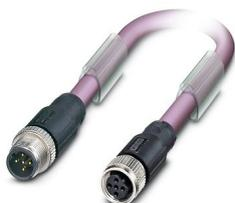
Câble préconfectionné pour bus, PROFIBUS, 2-pôles exempt d'halogène, blindé, connecteur mâle droit M12, détrompage: B, sur Connecteur femelle droit M12, détrompage: B, longueur de câble: 25 m
