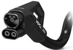
CHARX connect professional, Câble de charge DC HPC, avec connecteur de charge côté véhicule et extrémité de câble libre, pour la charge en courant continu (DC) des véhicules électriques (VE), prend en charge la mesure à quatre conducteurs, avec capteurs de température analogiques, avec cadre d'enfichage échangeable, avec contacts de puissance DC amovibles, avec contact PP raccordé, CCS type 2, selon CEI 62196-3, 375 A / 1000 V (DC), Logo PHOENIX CONTACT, câble: 4 m, noir, droit
