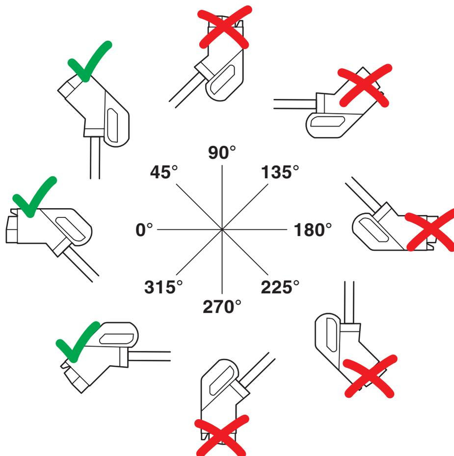
Montez le support du connecteur de charge dans la station de recharge uniquement pour que le consommateur final ne puisse pas brancher le connecteur de charge côté véhicule la tête en bas (90° à 270°). Il est cependant possible d'installer le connecteur tourné vers le haut (45°) ou vers le bas (315°) dans un support de connecteur de charge.
