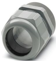
Presse-étoupe, matériau du raccordement vissé: PA, diamètre extérieur du câble 34 mm ... 44 mm, blindage: non, filetage de raccordement: M63 x 1,5, coloris: gris argent RAL 7001
