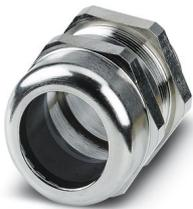
Presse-étoupe, matériau du raccordement vissé: Laiton, nickelé, diamètre extérieur du câble 34 mm ... 44 mm, blindage: non, filetage de raccordement: M63 x 1,5, coloris: argenté, avec joint torique
