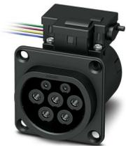
CHARX connect modular, Prise côté infrastructure, Rectangulaire, Basic, pour la charge en courant alternatif (AC) des véhicules électriques (VE), Type 2, CEI 62196-2, 32 A / 480 V (AC), sans fils individuels, actionneur de verrouillage: 12 V, 4 pôles, Montage sur la paroi arrière, Filetage M5, boîtiers: noir, Logo PHOENIX CONTACT
