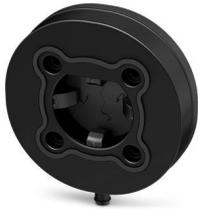
CHARX connect modular, Shutter pour prise côté infrastructure, rond, Accessoires, avec mécanisme à fermeture automatique, pour la mise en place sur les prises de charge côté infrastructure, Type 2, CEI 61851-1, IEC 62196-1, Montage face arrière, Filetage M5, Sans logo, Les capots de protection compatibles se trouvent parmi les accessoires.
