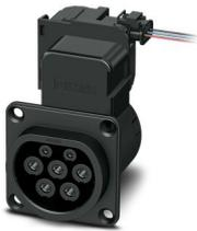
CHARX connect modular, Prise côté infrastructure, Rectangulaire, Premium, avec capteurs de température, avec LED (raccord de cathode commun), pour la charge en courant alternatif (AC) des véhicules électriques (VE), Type 2, CEI 62196-2, 32 A / 480 V (AC), sans fils individuels, actionneur de verrouillage: 12 V, 3 pôles, Montage sur la paroi arrière, Filetage M5, boîtiers: noir, Logo PHOENIX CONTACT
