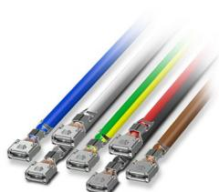
CHARX connect modular, Kit de câbles pour prise côté infrastructure, Accessoires, avec clip d'un seul côté, Uniquement pour le raccordement aux prises de charge côté infrastructure de la génération 2 de Phoenix Contact, Type 2, CEI 62196-2, 32 A / 480 V (AC), Fils individuels, longueur: 0,3 m, Montage par enfichage
