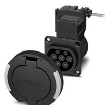
CHARX connect modular, Prise côté infrastructure, Rectangulaire, Basic, Kit, avec capot de protection rond, avec LED (raccord de cathode commun), pour la charge en courant alternatif (AC) des véhicules électriques (VE), Type 2, CEI 62196-2, 32 A / 480 V (AC), sans fils individuels, actionneur de verrouillage: 12 V, 3 pôles, Montage sur la paroi arrière, Filetage M5, boîtiers: noir, Logo PHOENIX CONTACT
