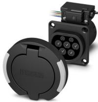
CHARX connect modular, Prise côté infrastructure, Rectangulaire, Premium, Kit, avec capot de protection rond, avec capteurs de température, avec LED (raccord de cathode commun), pour la charge en courant alternatif (AC) des véhicules électriques (VE), Type 2, CEI 62196-2, 32 A / 480 V (AC), sans fils individuels, actionneur de verrouillage: 12 V, 4 pôles, Montage sur la paroi arrière, Filetage M5, boîtiers: noir, Logo PHOENIX CONTACT
