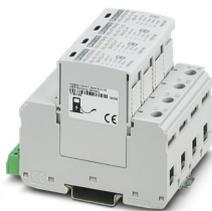
CHARX protect advanced : paratonnerre / parafoudre enfichable, conforme à type 1/2 / classe I/II, pour réseaux électriques triphasés avec conducteurs de neutre et de terre séparés (système à 5 conducteurs : L1, L2, L3, N, PE), avec contact de télésignalisation. Conçu spécialement pour une utilisation dans l'électromobilité.
