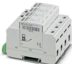
CHARX protect basic, parafoudre enfichable, conforme à type 2 / classe II, pour réseaux électriques triphasés avec conducteurs de neutre et de terre séparés (système à 5 conducteurs : L1, L2, L3, N, PE), avec contact de télésignalisation. Conçu spécialement pour une utilisation dans l'électromobilité.
