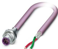
Connecteur d'appareil face arrière, PROFIBUS, 2-pôles exempt d'halogène, lilas rouge RAL 4001, blindé, Connecteur mâle, droit, M12, détrompage: B, sur extrémité libre, Montage face arrière, M16 x 1,5, Raccordement de câble, longueur de câble: 1 m, PROFIBUS, Produit de remplacement selon RoHS II sans exception 6c (Pb < 0,1 %) référence : 1239925
