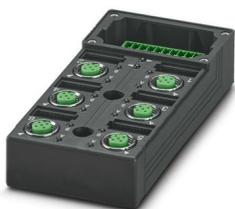
Répartiteur pour capteurs/actionneurs, embase, application : Standard, type de raccordement: Connecteur femelle M12 SPEEDCONNEC Métal, nombre de prises: 6, nombre de pôles: 5, détrompage: A, affectation des prises: double, affichage d'état: Oui, pnp; racc. câble multicond.: Raccordement vissé enfichable, blindage: non
