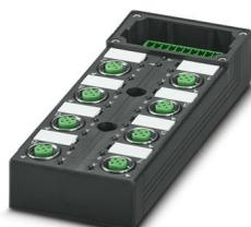
Embase, application : Standard, type de raccordement: Connecteur femelle M12 SPEEDCONNEC Métal, nombre de prises: 8, nombre de pôles: 5, détrompage: A, affectation des prises: double, affichage d'état: Oui, pnp; racc. câble multicond.: Raccordement vissé enfichable, blindage: non
