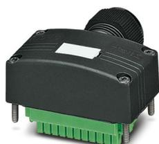
Capot de raccordement, application : Répartiteur pour capteurs/actionneurs, type de raccordement: Connecteur femelle M12 SPEEDCONNEC Métal / QUICKON, nombre de prises: 8, affectation des prises: double, affichage d'état: Non; racc. câble multicond.: Raccordement vissé enfichable 180°, PUR/PVC, longueur du câble: 15 m, blindage: non
