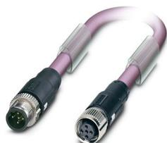
Câble préconfectionné pour bus, CANopen<sup>®</sup>, DeviceNet<sup>™</sup>, 5-pôles exempt d'halogène, blindé, connecteur mâle droit M12 SPEEDCONNEC, détrompage: A, sur Connecteur femelle droit M12 SPEEDCONNEC, détrompage: A, longueur de câble: 25 m
