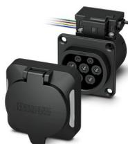
CHARX connect modular, Prise côté infrastructure, Rectangulaire, Premium, Kit, avec capot de protection carré, avec capteurs de température, avec LED (raccord de cathode commun), pour la charge en courant alternatif (AC) des véhicules électriques (VE), Type 2, CEI 62196-2, 32 A / 480 V (AC), sans fils individuels, actionneur de verrouillage: 12 V, 4 pôles, Montage sur la paroi arrière, Filetage M5, boîtiers: noir, Logo PHOENIX CONTACT
