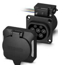
CHARX connect modular, Prise côté infrastructure, Rectangulaire, Basic, Kit, avec capot de protection carré, avec LED (raccord de cathode commun), pour la charge en courant alternatif (AC) des véhicules électriques (VE), Type 2, CEI 62196-2, 32 A / 480 V (AC), sans fils individuels, actionneur de verrouillage: 12 V, 4 pôles, Montage sur la paroi arrière, Filetage M5, boîtiers: noir, Logo PHOENIX CONTACT
