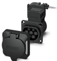
CHARX connect modular, Prise côté infrastructure, Rectangulaire, Premium, Kit, avec capot de protection carré, avec capteurs de température, avec LED (raccord de cathode commun), pour la charge en courant alternatif (AC) des véhicules électriques (VE), Type 2, CEI 62196-2, 32 A / 480 V (AC), sans fils individuels, actionneur de verrouillage: 12 V, 3 pôles, Montage sur la paroi arrière, Filetage M5, boîtiers: noir, Logo PHOENIX CONTACT
