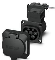
CHARX connect modular, Prise côté infrastructure, Rectangulaire, Basic, Kit, avec capot de protection carré, avec LED (raccord de cathode commun), pour la charge en courant alternatif (AC) des véhicules électriques (VE), Type 2, CEI 62196-2, 32 A / 480 V (AC), sans fils individuels, actionneur de verrouillage: 12 V, 3 pôles, Montage sur la paroi arrière, Filetage M5, boîtiers: noir, Logo PHOENIX CONTACT
