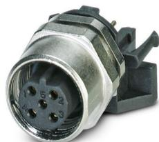
Connecteur d'appareil face arrière, 5-pôles, connecteur femelle, droit, M12-SPEEDCONNEC, détrompage: B, Montage face arrière, M12 x 1, Picots de soudage, Produit de remplacement selon RoHS II sans exception 6c (Pb < 0,1 %) référence : 1239952
