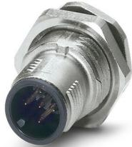
Connecteur d'appareil face arrière, 5-pôles, Connecteur mâle, droit, M12-SPEEDCONN, détrompage: A, Montage face arrière, Pg9, Picots de soudage, Produit de remplacement selon RoHS II sans exception 6c (Pb < 0,1 %) référence : 1239960
