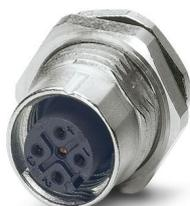
Connecteur d'appareil face arrière, 5-pôles, connecteur femelle, droit, M12-SPEEDCONN, détrompage: A, Montage face arrière, Pg9, Picots de soudage, Produit de remplacement selon RoHS II sans exception 6c (Pb < 0,1 %) référence : 1237395
