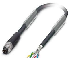
Câble préconfectionné pour bus, INTERBUS, 4-pôles exempt d'halogène, blindé, connecteur mâle droit M8, détrompage: A, sur extrémité libre, longueur de câble: 20 m
