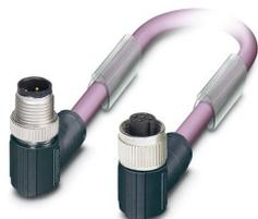
Câble préconfectionné pour bus, CANopen<sup>®</sup>, DeviceNet<sup>™</sup>, 5-pôles, connecteur mâle coudé M12, détrompage: A, sur Connecteur femelle coudé M12, détrompage: A, longueur de câble: 5 m
