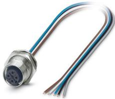
Connecteur d'appareil face arrière, Universel, 5-pôles, connecteur femelle, droit, M12-SPEEDCONNEC, détrompage: A, sur extrémité libre, Montage face arrière, Pg9, Cordons individuels, longueur de câble: 0,5 m, 0,50 mm<sup>2</sup>, Cordon PVC
