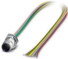
Connecteur d'appareil face arrière, Universel, 8-pôles, Connecteur mâle, droit, M12-SPEEDCONNEC, détrompage: A, sur extrémité libre, Montage face arrière, M12 x 1, Cordons individuels, longueur de câble: 0,5 m, 0,25 mm<sup>2</sup>, Cordon TPE, Produit de remplacement selon RoHS II sans exception 6c (Pb < 0,1 %) référence : 1240003
