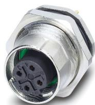
Connecteur d'appareil face arrière, 4-pôles, connecteur femelle, droit, M12-SPEEDCONNEC, détrompage: D, Montage face arrière, Pg9, Picots de soudage, Produit de remplacement selon RoHS II sans exception 6c (Pb < 0,1 %) référence : 1240010
