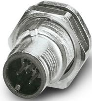
Connecteur d'appareil face arrière, 5-pôles, Connecteur mâle, droit, M12-SPEEDCONN, détrompage: A, Montage face arrière, Pg9, Picots de soudage, Produit de remplacement selon RoHS II sans exception 6c (Pb < 0,1 %) référence : 1240014
