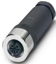
Connecteur, Universel, 4-pôles, connecteur femelle droit M12, détrompage: A, Raccordement vissé, matériau de la molette: Acier inoxydable 1.4404, presse-étoupe Pg9, diamètre extérieur du câble 6 mm ... 8 mm
