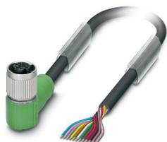
Câble pour capteurs/actionneurs, 12-pôles, extrémité libre, sur Connecteur femelle coudé M12 SPEEDCONNec, détrompage: A, longueur de câble: 10 m
