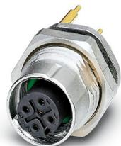
Connecteur d'appareil face arrière, 5-pôles, connecteur femelle, droit, M12-SPEEDCONN, détrompage: A, Montage face arrière, Pg9, Picots de soudage, Produit de remplacement selon RoHS II sans exception 6c (Pb < 0,1 %) référence : 1240062
