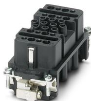
Élément de contact, nombre de pôles: 10+16+10+2PE, taille: B16, contacts de puissance: 10, contacts de commande: 26, nombre de raccordements par pôle: 1, Connecteur femelle, Raccordement à sertir, 250 V, 10 A, 0,14 mm<sup>2</sup> ... 2,5 mm<sup>2</sup>
