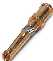
Contact à sertir, diamètre de contact: 1,6 mm, tournés, Connecteur femelle, matériau de contact: Alliage de cuivre, surface des contacts: doré, section raccordable: 0,5 mm<sup>2</sup> ... 0,5 mm<sup>2</sup>, AWG 20
