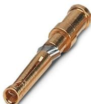
Contact à sertir, diamètre de contact: 1,6 mm, tournés, Connecteur femelle, matériau de contact: Alliage de cuivre, surface des contacts: doré, section raccordable: 0,75 mm<sup>2</sup> ... 0,75 mm<sup>2</sup>, AWG 18
