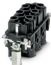
Élément de contact, nombre de pôles: 6+PE, taille: B16, contacts de puissance: 6, contacts de commande: 0, Connecteur femelle, Raccordement vissé, 1000 V, 80 A, 6 mm<sup>2</sup> ... 16 mm<sup>2</sup>, application: Puissance
