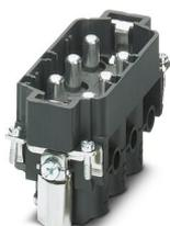
Élément de contact, nombre de pôles: 6+PE, taille: B16, contacts de puissance: 6, contacts de commande: 0, Mâle, Raccordement vissé, 1000 V, 80 A, 6 mm<sup>2</sup> ... 16 mm<sup>2</sup>, application: Puissance
