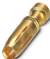
Contact à sertir, diamètre de contact: 2,5 mm, tournés, Connecteur femelle, matériau de contact: Alliage de cuivre, surface des contacts: doré, section raccordable: 0,14 mm<sup>2</sup> ... 0,37 mm<sup>2</sup>, AWG 22 ... 26
