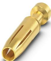
Contact à sertir, diamètre de contact: 2,5 mm, tournés, Connecteur femelle, matériau de contact: Alliage de cuivre, surface des contacts: doré, section raccordable: 0,75 mm<sup>2</sup> ... 1 mm<sup>2</sup>, AWG 18
