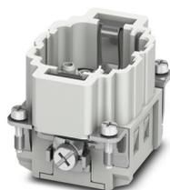
Élément de contact, nombre de pôles: 18+PE, taille: B10, nombre de raccordements par pôle: 1, Mâle, Raccordement à sertir, 500 V, 16 A, 0,5 mm<sup>2</sup> .. 4 mm<sup>2</sup>
