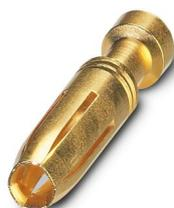
Contact à sertir, diamètre de contact: 2,5 mm, tournés, Connecteur femelle, matériau de contact: Alliage de cuivre, surface des contacts: doré, section raccordable: 1,5 mm<sup>2</sup> ... 1,5 mm<sup>2</sup>, AWG 16
