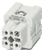
Élément de contact, nombre de pôles: 3+PE, taille: D7, nombre de raccordements par pôle: 1, Connecteur femelle, Raccordement Push-in, 230 V/400 V, 10 A, 0,14 mm<sup>2</sup> ... 1,5 mm<sup>2</sup>
