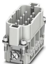
Élément de contact, nombre de pôles: 10+PE, taille: D15, nombre de raccordements par pôle: 1, Mâle, Raccordement vissé, 250 V, 16 A, 0,5 mm<sup>2</sup> ... 2,5 mm<sup>2</sup>
