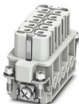
Élément de contact, nombre de pôles: 10+PE, taille: D15, nombre de raccordements par pôle: 1, Connecteur femelle, Raccordement vissé, 250 V, 16 A, 0,5 mm<sup>2</sup> ... 2,5 mm<sup>2</sup>
