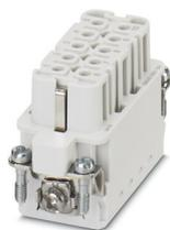
Élément de contact, nombre de pôles: 10+PE, taille: D15, nombre de raccordements par pôle: 1, Connecteur femelle, Raccordement Push-in, 250 V, 16 A, 0,14 mm<sup>2</sup> ... 2,5 mm<sup>2</sup>
