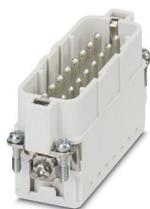
Élément de contact, nombre de pôles: 16+PE, taille: D25, Mâle, Raccordement Push-in, 250 V, 16 A, 0,14 mm<sup>2</sup> ... 2,5 mm<sup>2</sup>
