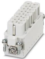
Élément de contact, nombre de pôles: 16+PE, taille: D25, Connecteur femelle, Raccordement Push-in, 250 V, 16 A, 0,14 mm<sup>2</sup> ... 2,5 mm<sup>2</sup>
