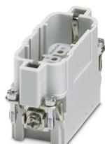
Élément de contact, nombre de pôles: 10+PE, taille: D15, nombre de raccordements par pôle: 1, Mâle, Raccordement à sertir, 250 V, 16 A, 0,5 mm<sup>2</sup> ... 4 mm<sup>2</sup>
