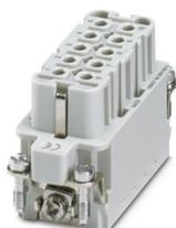
Élément de contact, nombre de pôles: 10+PE, taille: D15, nombre de raccordements par pôle: 1, Connecteur femelle, Raccordement à sertir, 250 V, 16 A, 0,5 mm<sup>2</sup> ... 4 mm<sup>2</sup>
