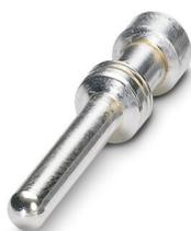
Contact à sertir, diamètre de contact: 2,5 mm, tournés, Mâle, matériau de contact: Alliage de cuivre, surface des contacts: plaqué argent, section raccordable: 0,5 mm<sup>2</sup> ... 0,5 mm<sup>2</sup>, AWG 20
