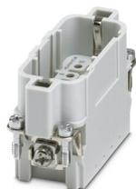
Élément de contact, nombre de pôles: 10+PE, taille: D15, nombre de raccordements par pôle: 1, Mâle, Raccordement à sertir, 250 V, 16 A, 0,5 mm<sup>2</sup> .. 4 mm<sup>2</sup>
