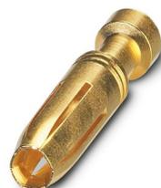
Contact à sertir, diamètre de contact: 2,5 mm, tournés, Connecteur femelle, matériau de contact: Alliage de cuivre, surface des contacts: doré, section raccordable: 1,5 mm<sup>2</sup> ... 1,5 mm<sup>2</sup>, AWG 16
