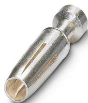
Contact à sertir, diamètre de contact: 2,5 mm, tournés, Connecteur femelle, matériau de contact: Alliage de cuivre, sans plomb, surface des contacts: plaqué argent, section raccordable: 3 mm<sup>2</sup> ... 3 mm<sup>2</sup>, AWG 12
