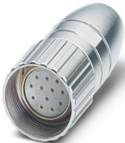
M23, Connecteurs à câble, droit, blindé: non, Verrouillage à vis, Nombre de pôles: 8+1, Sens de rotation: standard, type de contact: Connecteur femelle, Cône de soudage, plage de diamètre de câble: 9,5 mm ... 10,5 mm, détrompage: N, Produit de remplacement selon RoHS II sans exception 6c (Pb < 0,1 %) référence : 1240672
