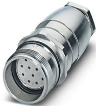
M23, Connecteur prolongateur, série: RC, droit, blindé: non, Verrouillage à vis, Nombre de pôles: 12, Sens de rotation: standard, type de contact: Connecteur femelle, Cône de soudage, plage de diamètre de câble: 7 mm ... 10 mm, détrompage: N
