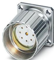
M23, Connecteur d'appareil face avant avec écrou moleté, série: RC, droit, blindé: non, Verrouillage à vis, Nombre de pôles: 16+3, Sens de rotation: standard, type de contact: Connecteur femelle, Cône de soudage, Joint plat, 4x Ø 3,2, détrompage: N
