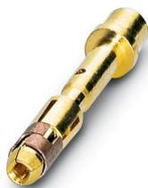
Contact à sertir, Connecteur femelle, tournés, Contact unique, diamètre de contact: 1 mm, zone de sertissage: 0,5 mm<sup>2</sup> ... 1 mm<sup>2</sup>, Produit de remplacement selon RoHS II sans exception 6c (Pb < 0,1 %) référence : 1241923
