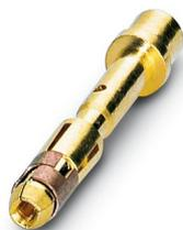
Contact à sertir, Connecteur femelle, tournés, Contact unique, diamètre de contact: 1 mm, zone de sertissage: 0,06 mm<sup>2</sup> ... 0,25 mm<sup>2</sup>, Produit de remplacement selon RoHS II sans exception 6c (Pb < 0,1 %) référence : 1241922
