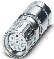
Connecteurs à câble, droit, court, Verrouillage à vis, M23, nombre de pôles: 4+3+PE, type de contact: Connecteur femelle, blindé: oui, indice de protection: IP67, plage de diamètre de câble: 7,5 mm ... 14 mm, nombre de pôles: 8, type de raccordement: Raccordement à sertir, série: SF, Produit de remplacement selon RoHS II sans exception 6c (Pb < 0,1 %) référence : 1241938
