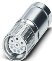
Connecteurs à câble, droit, long, Verrouillage à vis, M23, nombre de pôles: 4+3+PE, type de contact: Connecteur femelle, blindé: oui, indice de protection: IP67, plage de diamètre de câble: 9 mm ... 12 mm, nombre de pôles: 8, type de raccordement: Raccordement à sertir, série: SF, Produit de remplacement selon RoHS II sans exception 6c (Pb < 0,1 %) référence : 1241942
