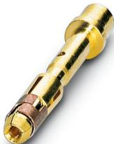
Contact à sertir, Connecteur femelle, tournés, Contact unique, diamètre de contact: 1 mm, zone de sertissage: 0,06 mm<sup>2</sup> ... 0,25 mm<sup>2</sup>, Produit de remplacement selon RoHS II sans exception 6c (Pb < 0,1 %) référence : 1241922
