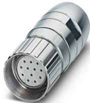
M23, Connecteurs à câble, série: UC, droit, blindé: oui, Verrouillage à vis, Nombre de pôles: 12, Sens de rotation: inversé, type de contact: Connecteur femelle, Cône de soudage, plage de diamètre de câble: 7 mm ... 8,5 mm, détrompage: N, Produit de remplacement selon RoHS II sans exception 6c (Pb < 0,1 %) référence : 1242124
