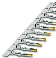
Contact à sertir, Connecteur femelle, roulés, Produits en bande, nombre de pièces par bande: 10000, diamètre de contact: 1 mm, zone de sertissage: 0,08 mm<sup>2</sup> ... 0,22 mm<sup>2</sup>
