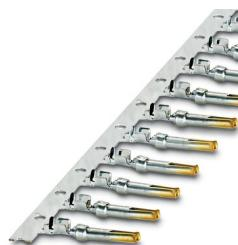
Contact à sertir, Connecteur femelle, roulés, Produits en bande, nombre de pièces par bande: 500, diamètre de contact: 1 mm, zone de sertissage: 0,08 mm<sup>2</sup> ... 0,22 mm<sup>2</sup>
