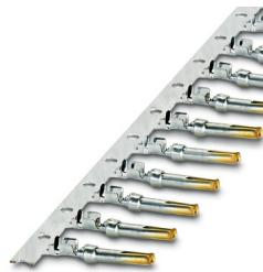
Contact à sertir, Connecteur femelle, roulés, Produits en bande, nombre de pièces par bande: 10000, diamètre de contact: 1 mm, zone de sertissage: 0,22 mm<sup>2</sup> ... 0,56 mm<sup>2</sup>, L'article est sans plomb, conformément à la directive RoHS II, sans exception 6c (Pb < 0,1 %)
