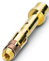
Contact à sertir, Connecteur femelle, tournés, diamètre de contact: 1 mm, zone de sertissage: 0,25 mm<sup>2</sup> ... 1 mm<sup>2</sup>, Produit de remplacement selon RoHS II sans exception 6c (Pb < 0,1 %) référence : 1243216
