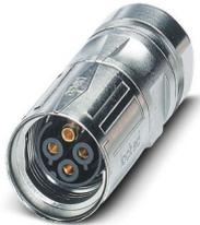
Connecteurs à câble, droit, SPEEDCONNEC, M17, nombre de pôles: 5+PE, type de contact: Connecteur femelle, blindé: oui, indice de protection: IP67, plage de diamètre de câble: 5 mm ... 8 mm, nombre de pôles: 6, type de raccordement: Raccordement à sertir, série: ST, Produit de remplacement selon RoHS II sans exception 6c (Pb < 0,1 %) référence : 1242349
