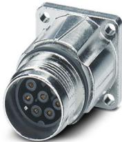
Embases paroi avant, droit, Pour verrouillage standard et SPEEDCON, M17, nombre de pôles: 7+PE, type de contact: Connecteur femelle, Joint torique axial, 4x Ø2,7, blindé: oui, cote de bride: 21,6 mm x 21,6 mm, indice de protection: IP67, nombre de pôles: 8, type de raccordement: Raccordement à sertir, série: ST
