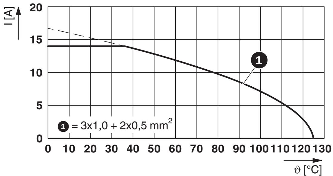
I = intensité,  $\vartheta$  = température ambiante, 3 x 14 A + 2 x 2 A stables
